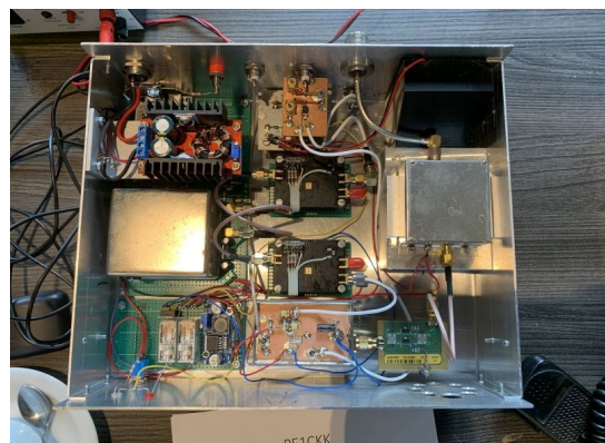
▼ QO-100 zelfbouw zendantenne 2,4 GHz (13cm) en QO-100 z/o transverter van PE1CCK
