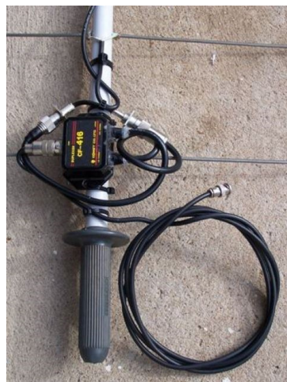
Afb 2 Een deel van de IOio antenne met de duplexer
