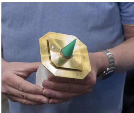
▼ QO-100 zelfbouw zendantenne 2,4 GHz (13cm) en QO-100 z/o transverter van PE1CCK
