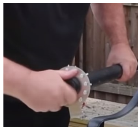
▲ De basisplaat voor de radialen word aan de mast vastgeschroefd (Foto Youtube, MØMCX)
