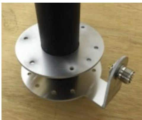
▲ De aluminium radiaal- en stralerplaten (Foto MØMCX)
