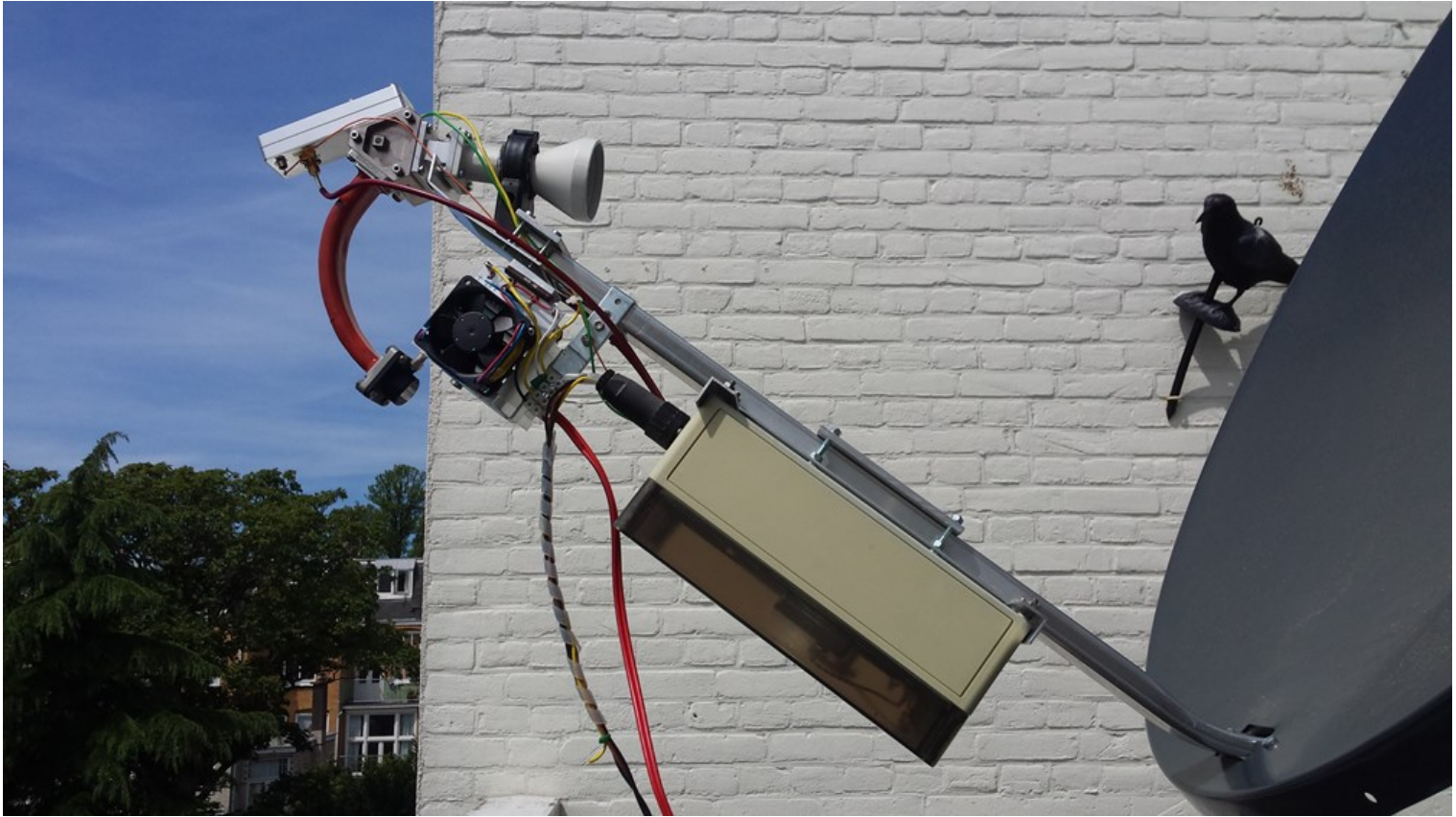
▲ De complete 3 cm PA met voorop de TGA2623-CP en bovenop de voeding. Alles uiteraard extreem goed gekoeld :-)
