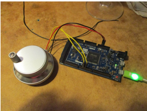
De hardware voor dit project. Links de afstemknop, rechts de Arduino DUO. Met een 'gewone' arduino UNO) lukt het ook prima.
