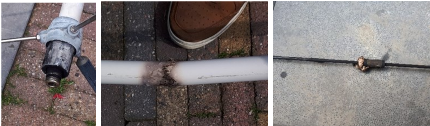
▲ Foto's : Diamond X50 gekookt, foto 3 laat de binnenkant, of beter gezegd wat er van over is, zien.
