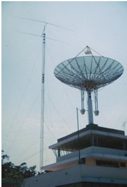
7 elements richtantenne voor 10, 15 and 20 meter
