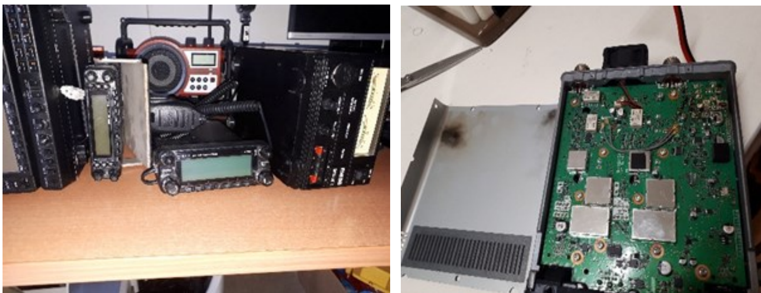
▲ Foto's: Blikseminslag in apparatuur. Vaak is het voedingsgedeelte helemaal vernield
