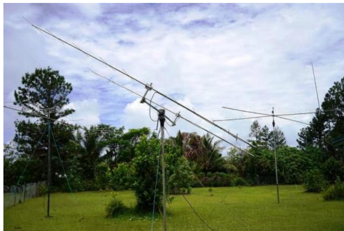
2x12 Elements M2 144MHz 6m Boom met volledige elevatie
