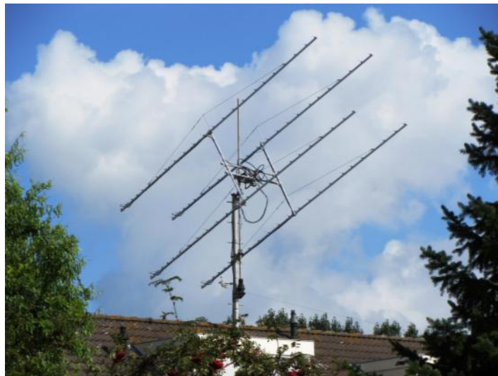
De 4x 24 –elements array op het dak
