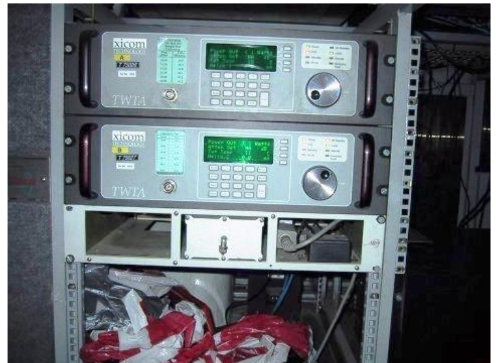
De beide 300W eindtrappen voor 14,5 GHz van de BT-wagen, samen met de schotel goed voor 30 megawatt ERP.
