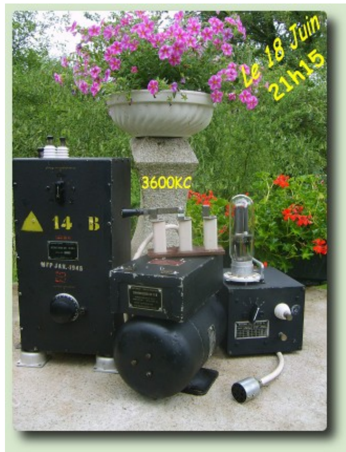
Op de foto de bekende VT4C buis, die in een BC 191 zender zit. Er zitten er maar liefst 4 van die grote buizen in...
