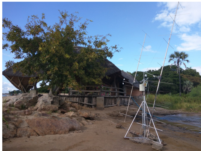
Op twee meter 2 x 8 el. kruisjagi voor zenden circulair gepolariseerd, voor ontvangst schakelbaar tussen 45 en 135 graden.
