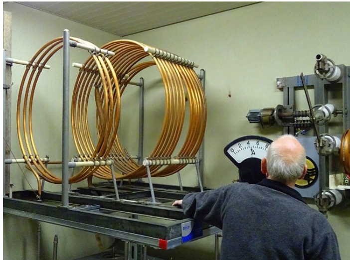
Afstellen van de uitkoppeling. En die HF-straling? Absoluut ongevaarlijk !
