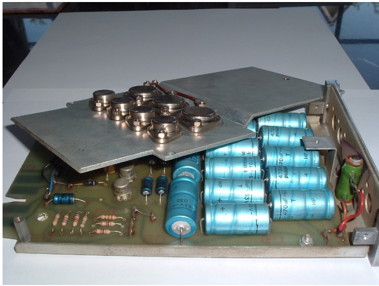
En er moet nog zo veel vervangen worden, meestal de blauwe elco's, want die zijn nu wel aan het eind van hun leven. Zo zit de 24 volt voeding vol met die elco's.
