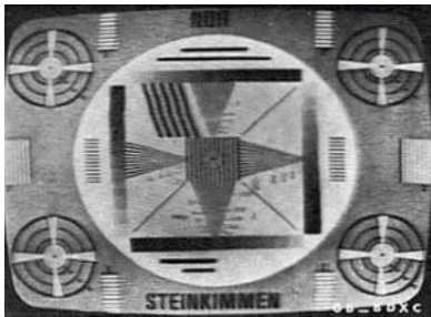
14) Kanaal E02 NDR-1 Steinkimmen [100 kW. ERP], met het IRT To5 testbeeld met de identificaties "NDR" (boven) en "STEINKIMMEN" (beneden), ~ 1971.
