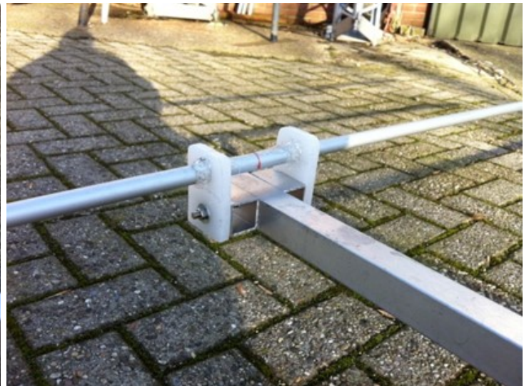
Montage van de reflector op de drager.
