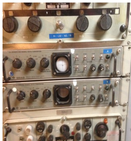
Telex-rek, inclusief monitor om de ontvanger goed af te kunnen stemmen, zodat de telex convertor de teletype data om kan zetten in signaal voor de telex.
