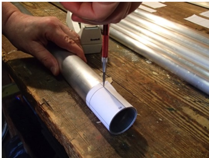
Markeren van de boorgaten en zaagsneden met de boormal
