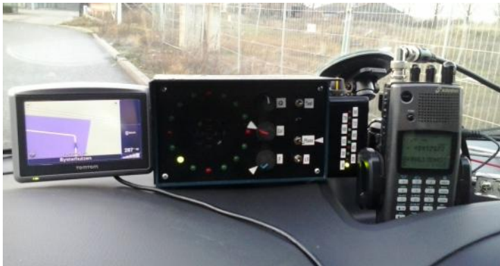
De laatste testuitvoering van de eenvoudigste (versie 1) PA8W doppler peiler, met wobbled pelorus en elevatie indicator voor vliegende radiobronnen...
