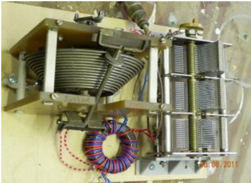
De proefopstelling met de Russische kegelvariometer
