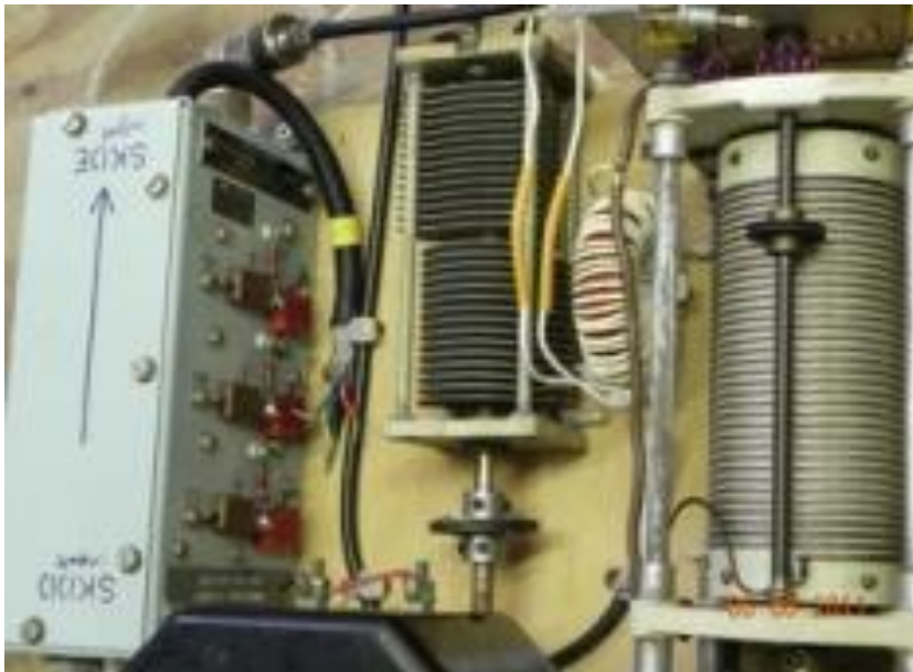
De S-match met de schone rolspool en de dump condensator. De tuner werkt tussen 3,5 en 24 MHz. In de definitieve versie komt i.p.v. de rolspool de kegelvariometer. Het werkt dan tussen 3,5 en 28 MHz. De nog niet aangesloten VSWR en Watt meter is te zien. Bij de uitgang zijn nog net de stroomtrafo's zichtbaar.
