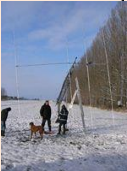
De 4-elements beam voor 15 meter.
