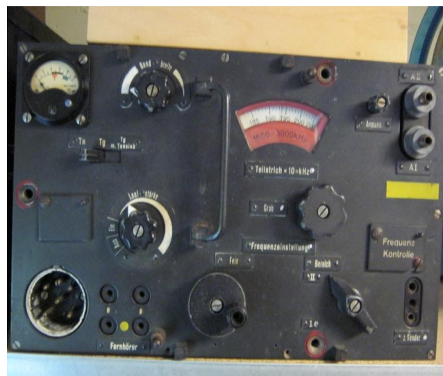
Duitse WW2 RX De MWEc. (tot 3MHz) Prima ontvanger vaak door amateurs ook gebruikt met een convertor. Erg mooi gemaakt, mechanisch juweel, elektrisch zeker voor die tijd een topontvanger. Omdat technici lang niet in kortegolf gebruik geloofden werd veel verkeer op de zgn grenzwellen gevoerd.
