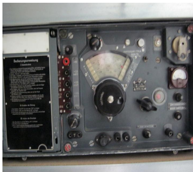
Een sovjetontvangertje dat tot in de tachtiger jaren gebruikt werd. Voeding uit een 2,4 V accu met omvormer. Het stroomverbruik is extreem laag. Loopt tot 20 MHz. Variabele MF bandbreedte. Gemaakt met bijzondere onderdelen en oerdegelijk.
