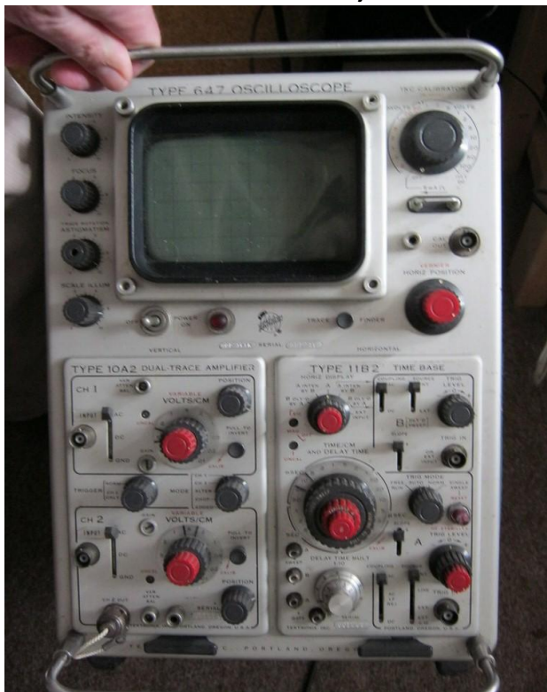
Een tektronixscoopuit de jaren zestig zoals ze op het lab werden gebruikt. Gekocht met Marshallhulp. Dit exemplaar zal meer dan toenmalige 10.000 gulden hebben gekost. Hij triggert nog moeiteloos tot boven 50 MHz. ook de verticale versterkers waren erg gevoelig en stabiel.
