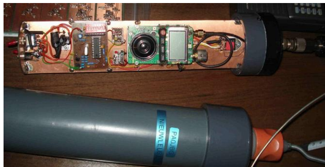
Figuur 1 Vossenjachtzender voor 144 en 432 MHz, opgebouwd rond het binnenwerk van een Baofeng-portofoon.
