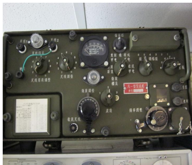
Een Chinese kloon van de beroemde GRC9. De opzet is praktisch identiek; alleen de antennenetner is beter. Wordt met losse ontvanger gebruikt en gevoed met een handgenerator die alleen geschikt is voor kleine chinese soldaatjes.
