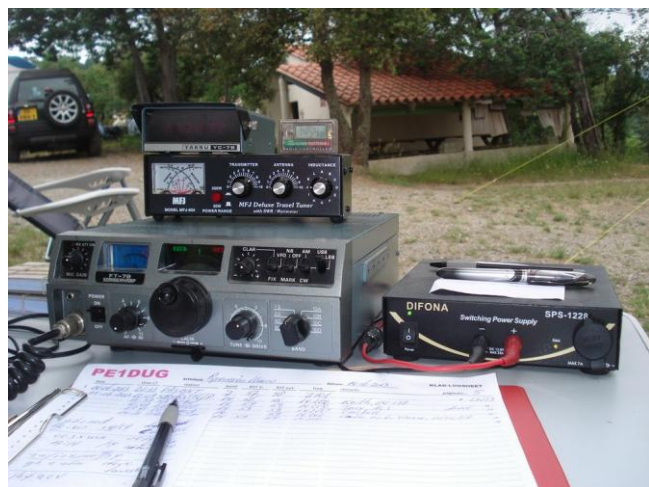
De apparatuur: een FT-7B met digitale frequentie-uitlezing, een MFJ-904 tuner en een geschakelde voeding.
