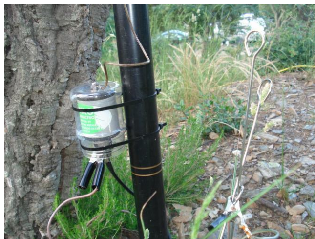
De tegen een kurkboom geplaatste hengel met een 1:9 impedantietrafo aan het onder-einde van de langdraad en shaslick-pennen als hoogohmige aarde.
