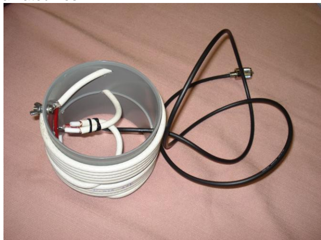
Marten PA3BNT toont een door hem gebouwde 1:4 Collins-balun voor 10 t/m 20 meter. Voor de
