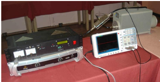
De complete AM-zender in demonstratie-opstelling en aangesloten op een 500 Watt-dummyload.
