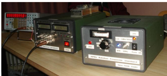
De meetapparatuur van Nanne PA3GIL. V.l.n.r. Racal-frequentieteller, zelfbouw GPS-ontvanger en zelfbouw rubidium-frequentiestandaard.
