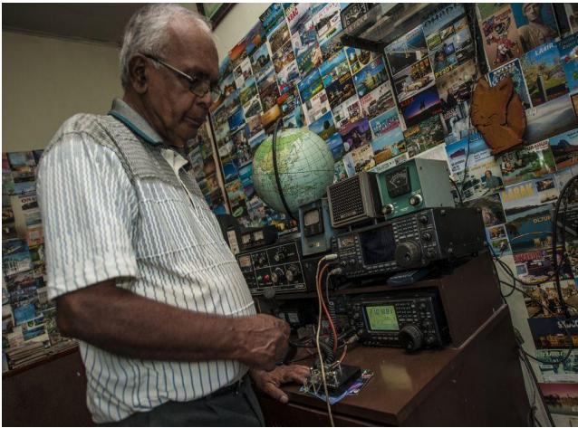
4S7NE werkt met twee defecte transceivers. Van de IC-756 (boven) werkt de display niet meer. Daarom checkt hij de frequentie op de IC-746 (beneden), die door blikseminslag een beschadigd front-end heeft.
