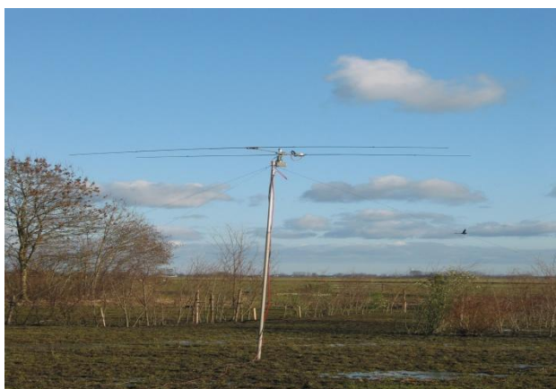
2-element 10 meter beam op surfmastje
