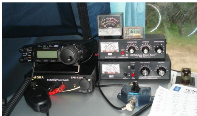
De (nieuwe) vakantie-opstelling met de Yaesu FT-857D en losse analoge meter, Difona SPS-1228 voeding, MFJ-904 (HF-banden), MFJ-906 (50 MHz), plus wat randspullen.
