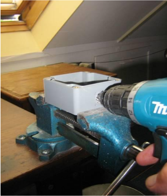
Boren van gat t.b.v. PL-chassisdeel met flens
