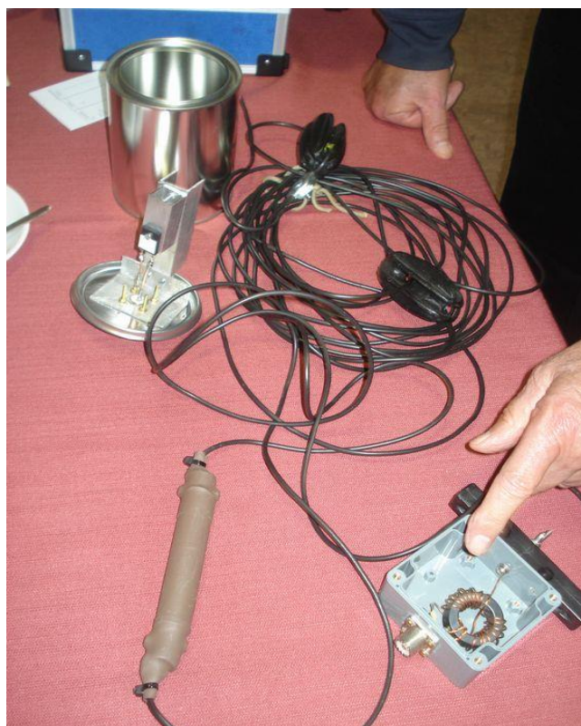
De zelfbouw Hi-end antenne en dummy load van Dick PD1T.
