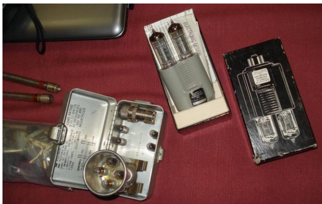
De spullen van Dick PA2DTA: selenium-gelijkrichters; dummy-load met lampjes AN/URM-13; op-amp met buizen.
