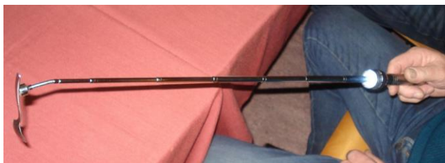
Zaklantaarn met telescoop-magneet van Douwe PA3DHP.
