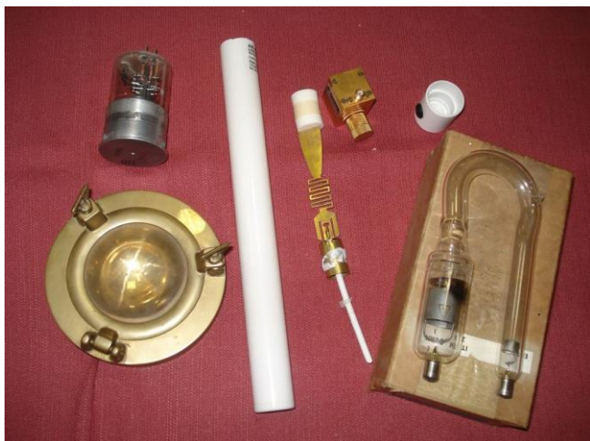
De spullen van Gerard PA3BCB: Telefunken triode-buis uit een Duitse nachtjager in WW-II; geheimzinnig scheepspatrijspoortje (?); antenne van een 2,4 GHz access-point; oscillator met impatt-diode en golfpijpe voor 110 GHz; gasontladingbuis (van een spectrocoop?).
