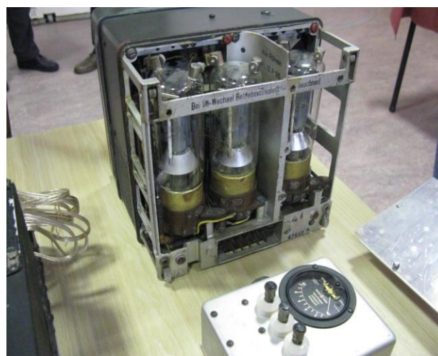
Onverwoestbare Telefunken buizen RL12P35 van de S10K
