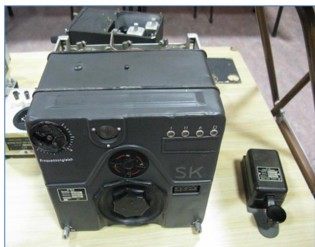
S10K zender met een frequentiebereik van 3 tot 6 MHz.
