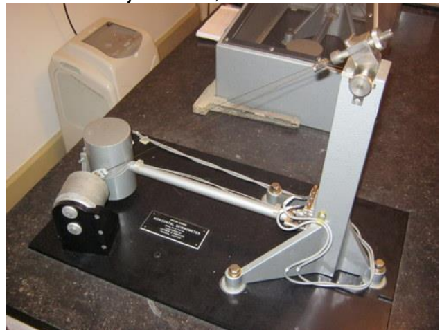
Mechanische seismometer met elektromagnetische uitlezing.
