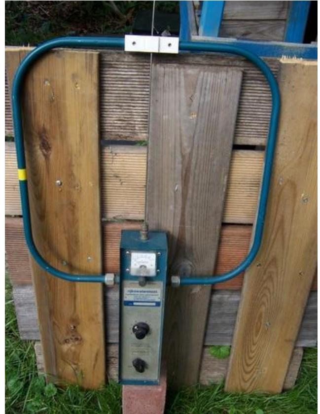
De peil ontvanger voor de boeien. Goed zijn de open antenne en de gesloten lus te zien.
