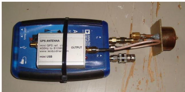
Adalm-PlutoSDR zendertje van 70 MHz tot 6 GHz voor de uplink naar de Es'hail-2 satelliet.
