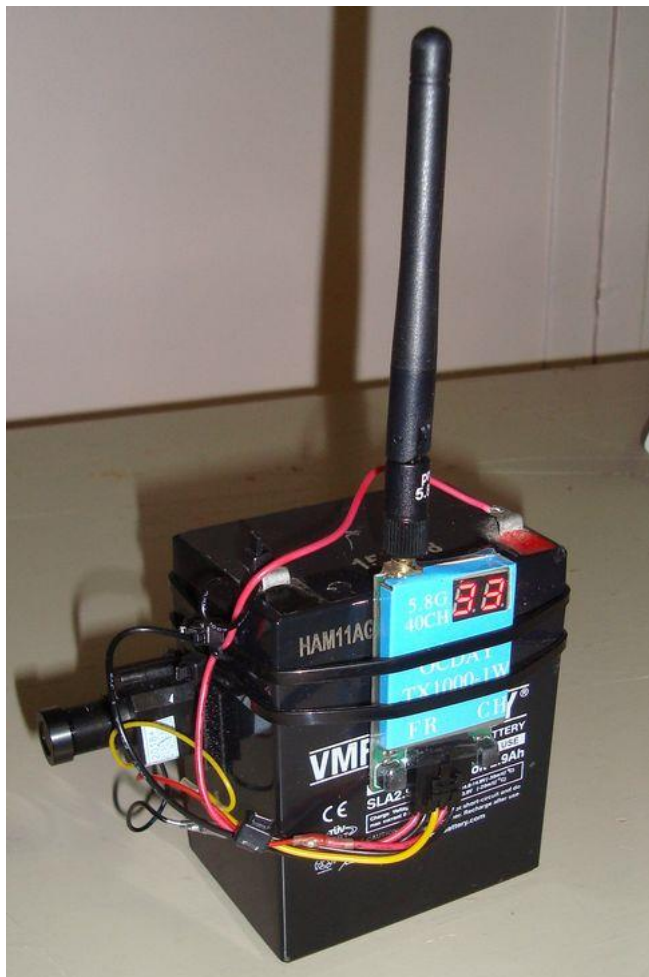
Video-zendertje op 5,6 GHz. De accu is veruit de grootste component.
