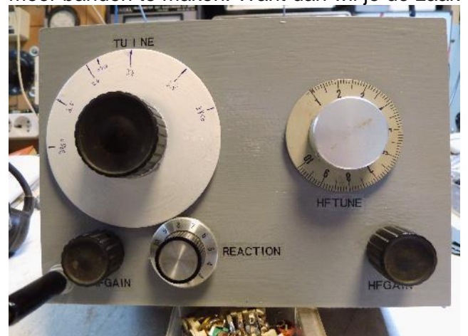
Afbeelding 4. De zelfbouw rechtuitontvanger 1-V-1 jaren vijftig met EF80/ECC82.
