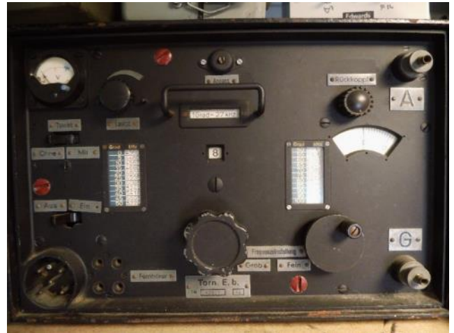
Afbeelding 2. Wehrmacht rechtuitontvanger Torn Eb (2-V-1 met RV2P800)
