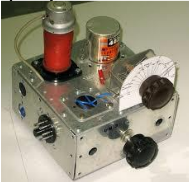
Foto NVHR: Ontvanger Philips Miniwatt penthode en een AMROH 402 spoel.
