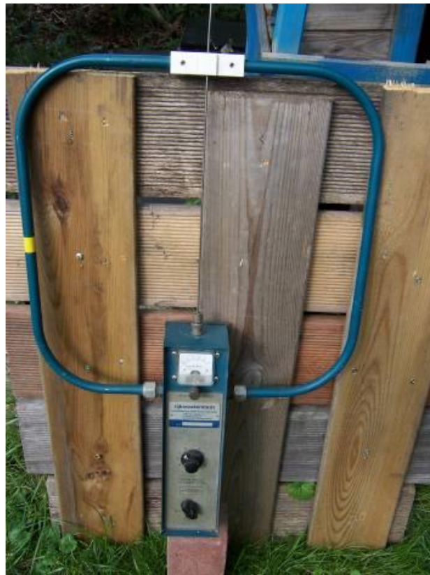
Afbeelding 18, de peilantenne voor golfmeet boeien
