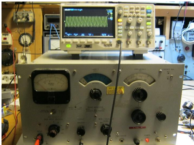
Foto , HP Wave Analyser 302A met Siglent digitale scoop en harmonische van een LF signaal generator dat via een draadje wordt uitgezonden.
