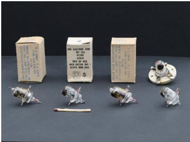
Afbeelding 1: enkele leden van de eikelbuizen familie, v.l.n.r. een steile penthode 954, een triode 955, een penthode 956 met regelkarakteristiek en een tweetal 9004 dioden waarvan één in eikelbuis sokkel.
