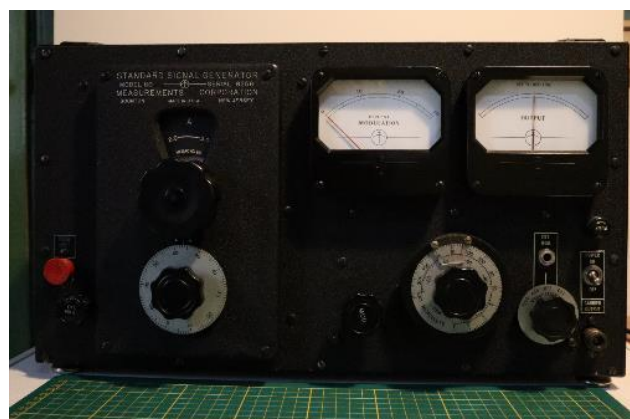
Afbeelding 13: Measurements Corporation Model 80 signaal generator met een bereik van 2 – 400 MHz in zes deelbereiken en vrijlopende oscillator uit +/- 1945.
