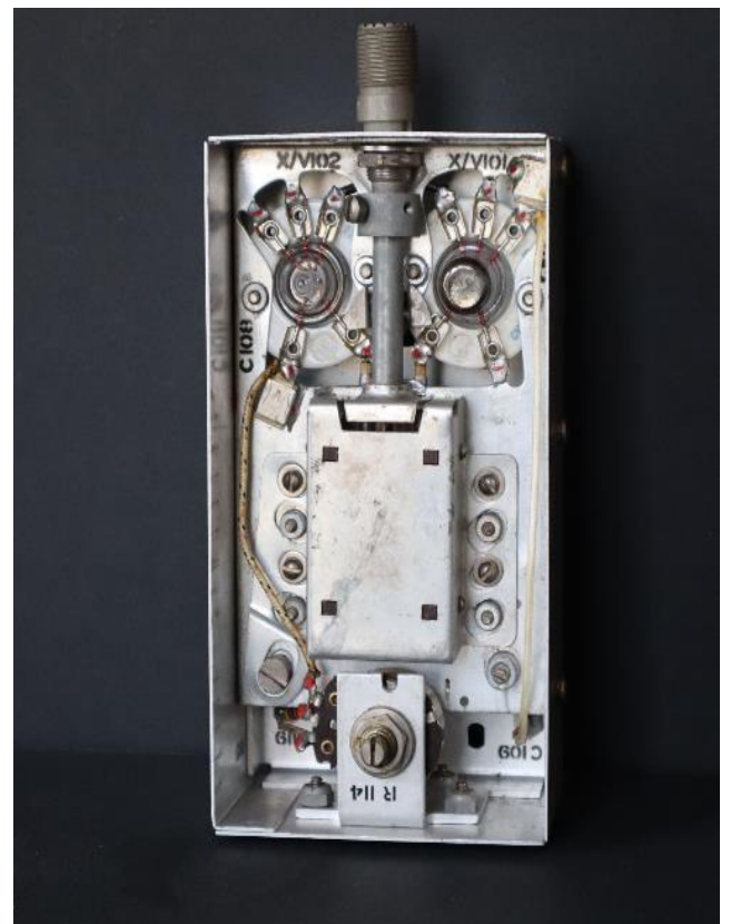
Afbeelding 19: de ontvanger ingangstrap van de APN-1 met twee dioden 9004 in balans
