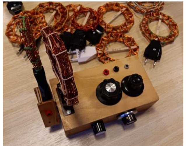
De bovenkant van het dominokistje met twee inductief gekoppelde korfspoelen.
