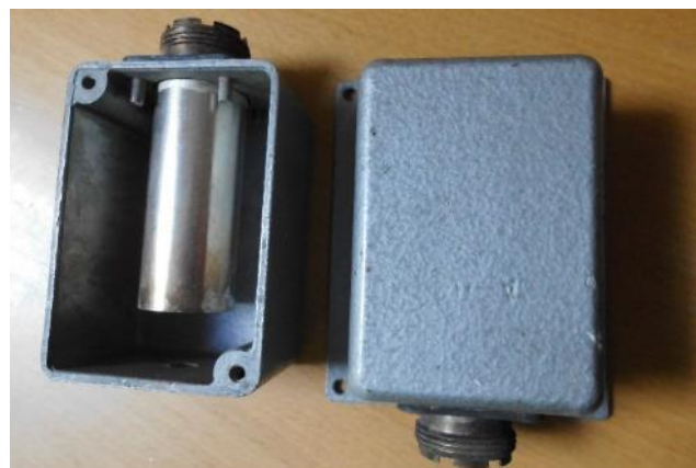
Ex Sovjet afsluitweerstand, ook gebruikt als mini dummyload. Door in een coaxilane vorm te bouwen met twee weerstanden van elk 150 Ohm werkt het toch tot 400 MHz
