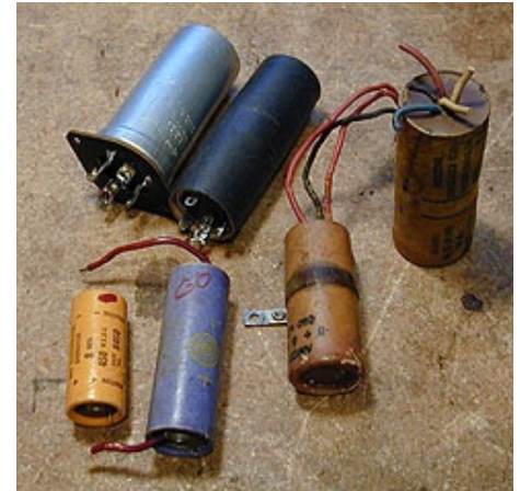
Verschillende uitvoeringen van de electrolytische condensator, ook wel Elco genoemd.
