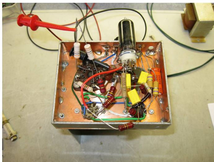
Test van het prototype van de voeding
