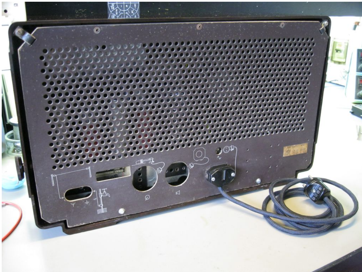
Foto 11: achterzijde met nieuw netsnoer en opnieuw gemonteerde originele stekkers.
