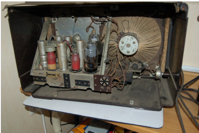
Foto 2: De achterzijde met stof en buizen die met leukoplast bij elkaar worden gehouden
