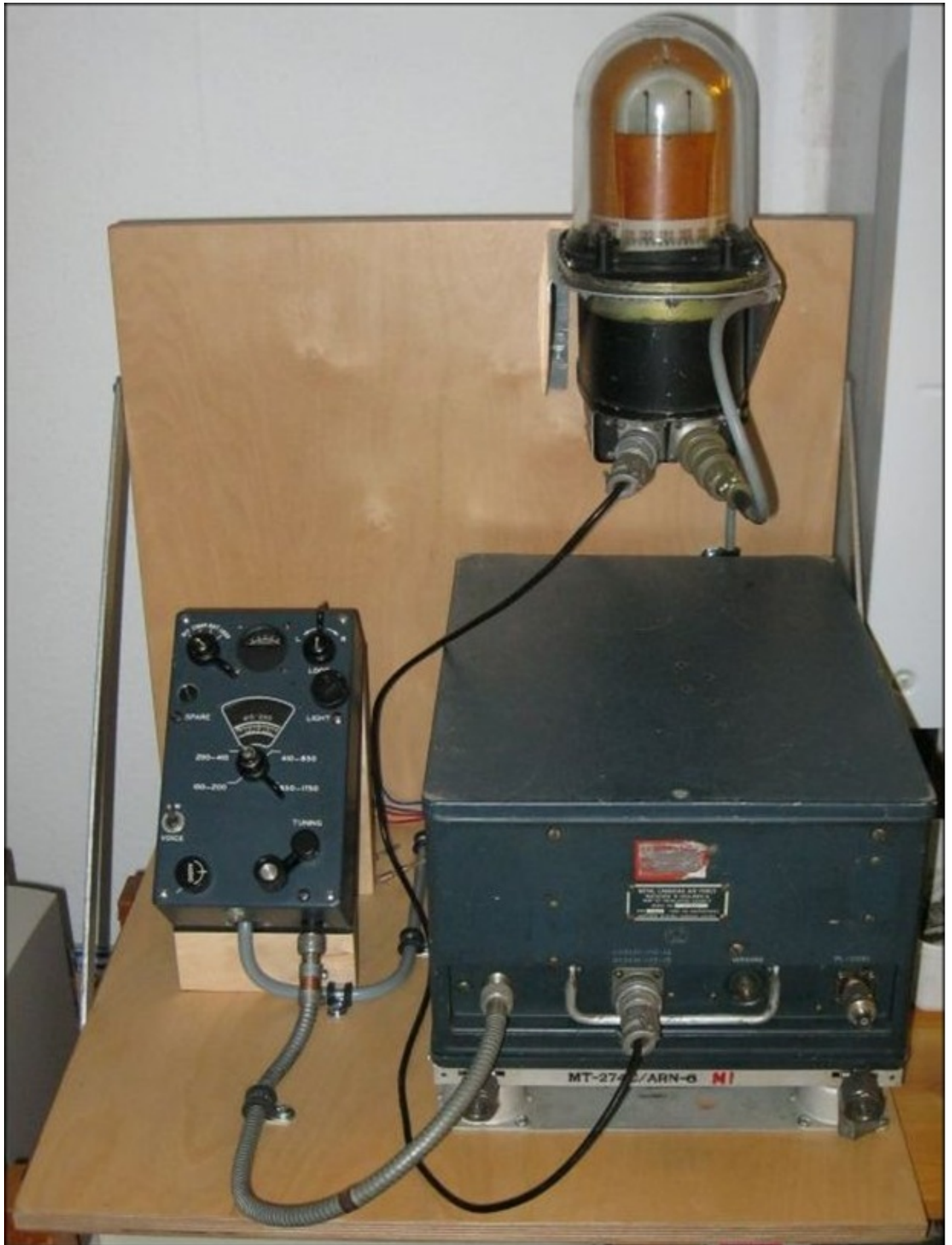
Mijn opstelling. Rechts R-101 op mounting met daarboven de loopantenne. Links het bedienkastje op mounting met de bowdenkabel naar ontvanger. Links van de loop is nog ruimte voor de indicator.
