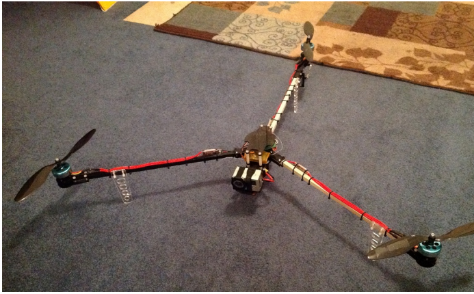
Tricopter. Meer dan 3 latjes met een propellor is het niet.
