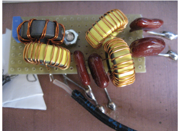
Praktische uitvoering van het 7MHz isolatie/laagdoorlaatfilter
