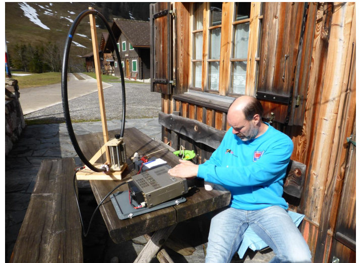
De loop-antenne in bedrijf.
