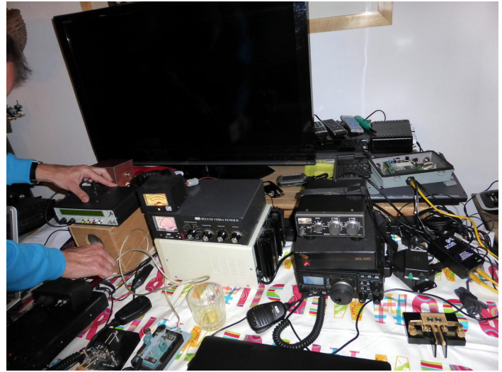
De tafel met de twee CW zenders: links een FT857 en rechts een FT897, beiden voorzien van keyer.
