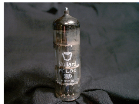
PCL86, triode-penthode. Ontworpen rond 1960
