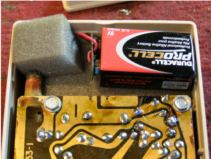
Beetje schuimrubber om de batterij te fixeren
