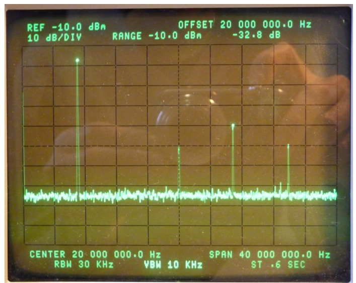
Fig. 11 LO leakage meting bij V_{DC\_LO} = 1.40V
