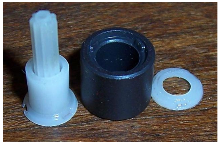
De hoofdas, de magnetische rotorkern hoort vast te zitten op de rondsel as, links. De ring is een centreerring die bovenop ook vast hoort te zitten. (bron: Poolse website)
