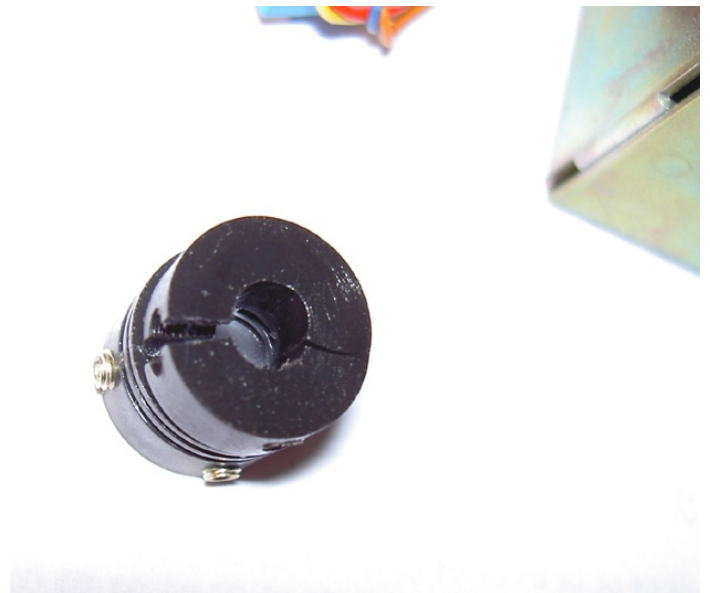
De koppelingbus. Er zijn twee openingen voor verschillende asdiameters: 5mm en 6mm
