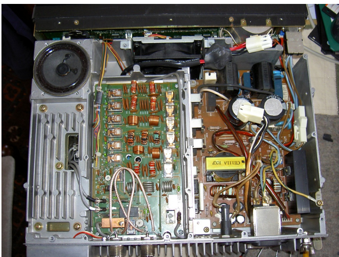
De filterunit is bovenop de eindtrap gemonteerd, de coaxlusjes onderaan zijn nieuwe, flexibele verbindingen naar de antenne aansluitingen. Rechts de geschakelde voeding.
