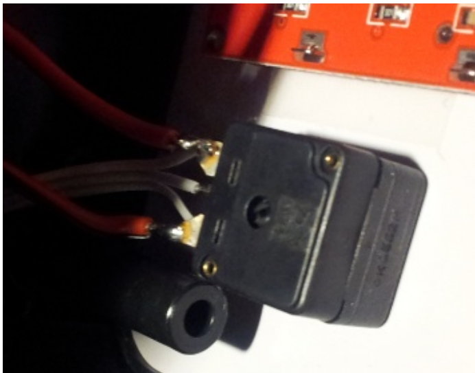
Links de potmeter met schakelaar. Boven: de twee relais. Let op de vertikaal gemonteerde spoelen zodat deze los van de print gemonteerd kunnen worden.
