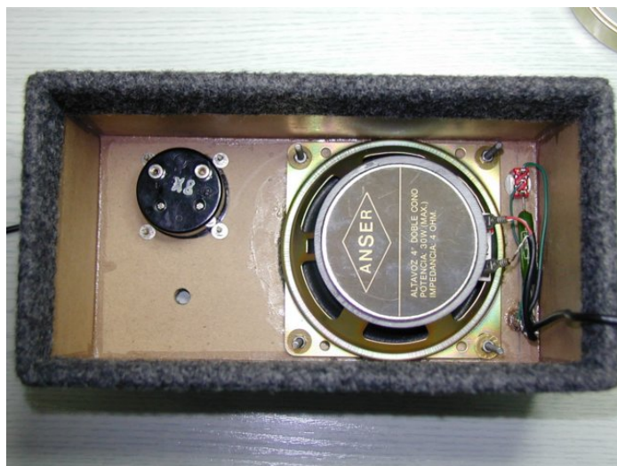
Meter, luidspreker en schakelaar om de luidspreker in te schakelen
