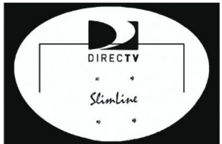
Figuur 4. Een horizontale slot-antenne, met afhangende uiteinden, uitgezaagd in een SlimLine DIRECTV schotel.
