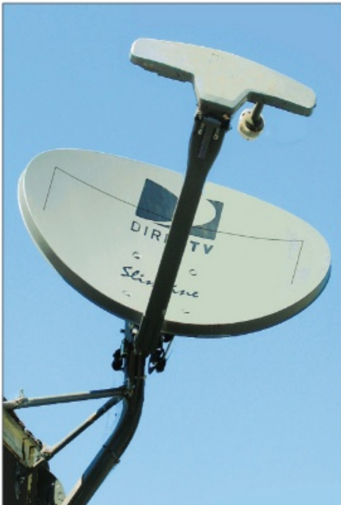
Figuur 1. Slot antenne in een TV-schotel. Let op de nauwelijks zichtbare zaagsnede in de antenne.
