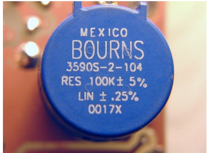
Figuur 15. Detail van de multi-turn potmeter
