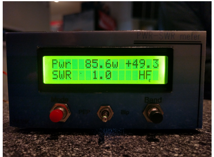
Kleine power/swr meter met geluidssignalen zodat je op gehoor kunt tunen, van Henny PA3HK
