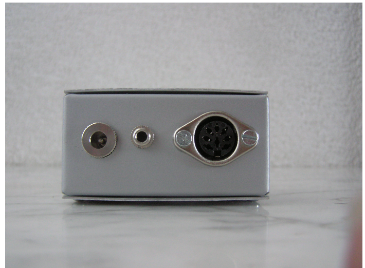
Achterzijde. Van links naar rechts: Voedingsaansluiting, audio uitgang, DIN ingang voor de platenspeler. Grammofoon. Pick-up.
