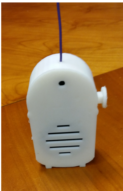
Figuur 10. De hele transceiver in een microfoon gebouwd. De aan/uit schakelaar is als draaibare magneet uitgevoerd op de achterzijde van het microfoon kapsel, en de draad is hier het op een kwart golflengte afgeknipte microfoonsnoer dat dienst doet als antenne van de transceiver! Met recht een draadloze microfoon...
