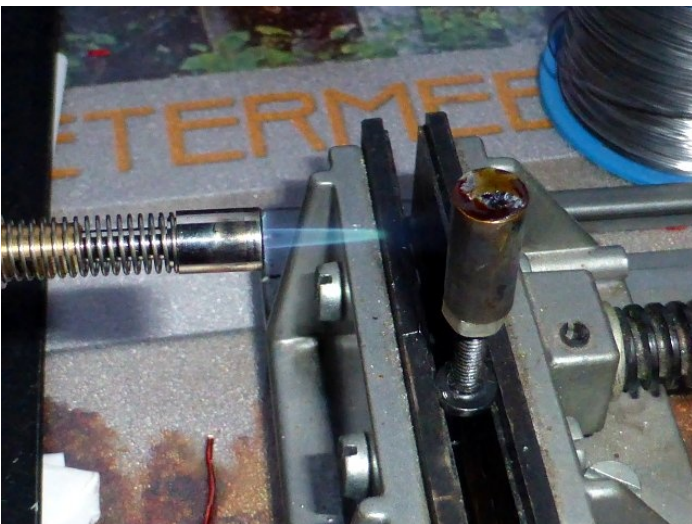
Aansteken, verwarmen en tin in het vat smelten.
