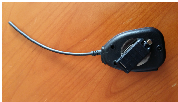
Figuur 10. De hele transceiver in een microfoon gebouwd. De aan/uit schakelaar is als draaibare magneet uitgevoerd op de achterzijde van het microfoon kapsel, en de draad is hier het op een kwart golflengte afgeknipte microfoonsnoer dat dienst doet als antenne van de transceiver! Met recht een draadloze microfoon...
